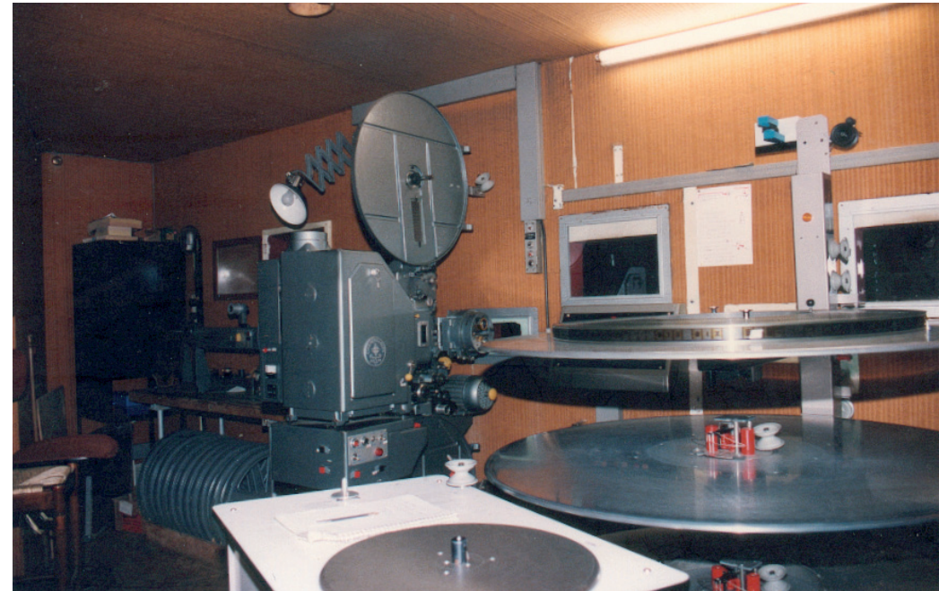
Le montage du film se faisait sur les plateaux où les bobines étaient collées entre elles. Le plateau intermédiaire pouvait recevoir un deuxième film.
