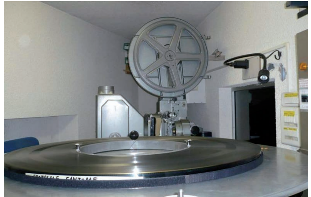
Le projecteur unique 35 mm nécessitait le montage préalable des films sur le dérouleur
